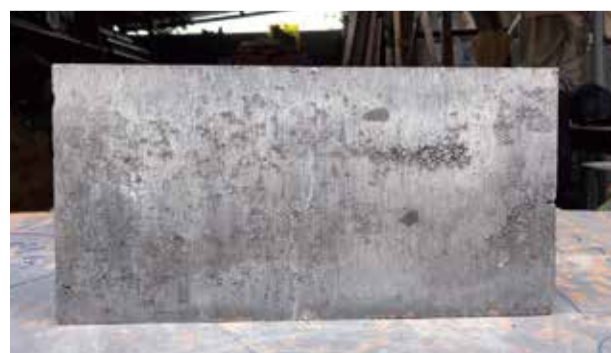
第1試作ブロック ブロックの表面に粗が多く色も黒味が強い
