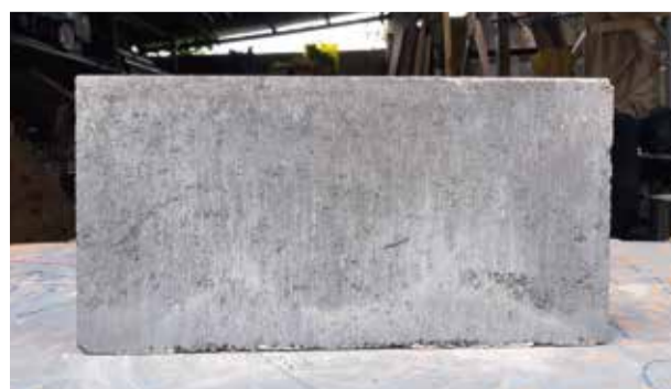
第3試作ブロック ブロック下方と上方表面の違いが目立つ
